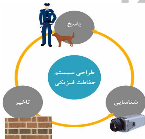
شکل ۲. طراحی سامانه حفاظت فیزیکی
